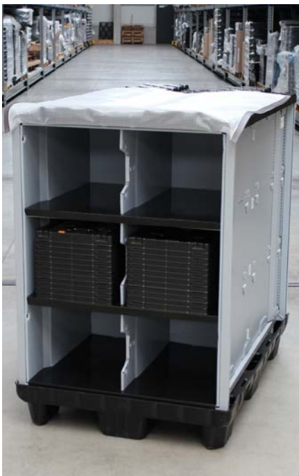
Compartimentos de estantería con bandejas elevadas para la manipulación de sistemas de contacto de celdas (1230 x 830 x 1210 mm).
