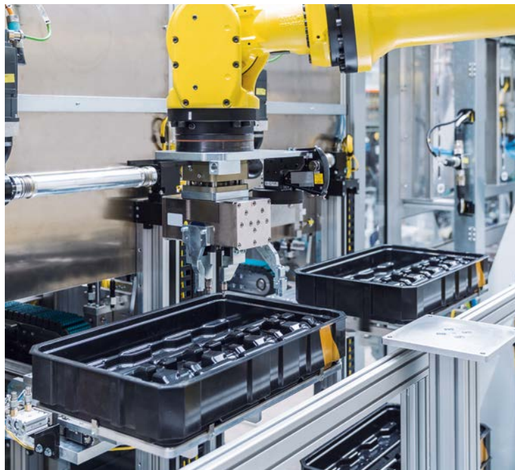
Bandeja rebajada en formato de 600 x 400 mm para portadores de HDP y tapas. Uso en una instalación de montaje automatizada.
