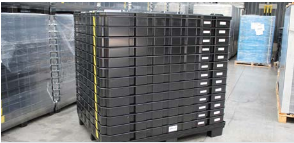
Unidad de embalaje compuesta por pallet, bandejas rebajadas y tapa para techos de cristal panorámicos (1466 x 1231 x 1473 mm).
