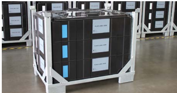
Ladungsträger in Runggengestell 1220 x 820 x 1000 mm für Rotor- und Stator-Blechpakete.
