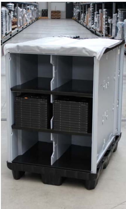
Regalgefache mit Werkstückträgern zum Handling von Zellkontaktiersystemen (1230 x 830 x 1210 mm).
