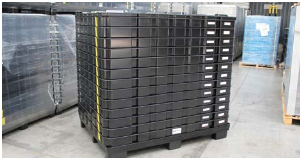
Ladeinheit bestehend aus Palette, Behältern und Deckel für Panorama-Glasdächer (1466 x 1231 x 1473 mm).
